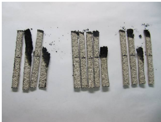
Figura 5. Probeta representativa del material DECOPROYEC-3: (a) durante el ensayo; (b) después del ensayo
